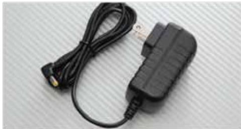
DC電源入力端子に接続して使用します
