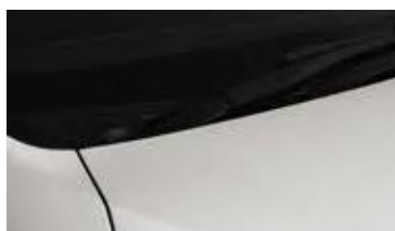
本製品をテープ等で仮付けし、マッチングを確認して下さい。
