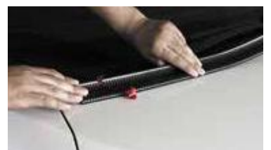
ドライヤー等で十分に温めてゆっくり曲げながら圧着して下さい。勢い良く曲げるとカーボン柄の変形やシワが入る場合がございます
