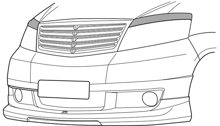
斜線部をよく脱脂洗浄して下さい。
