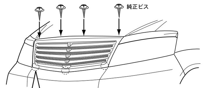
注意) 裏側を差し込む際、ナットが差し込み口に引掛からない様に調節して差し込んで下さい。
