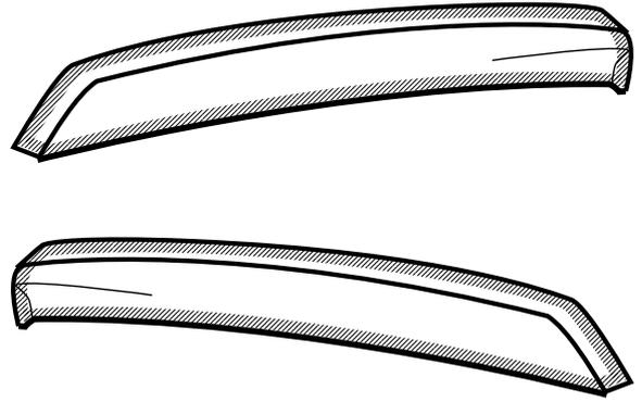
斜線部をよく脱脂洗浄した後、③両面テープを貼り付けます。
