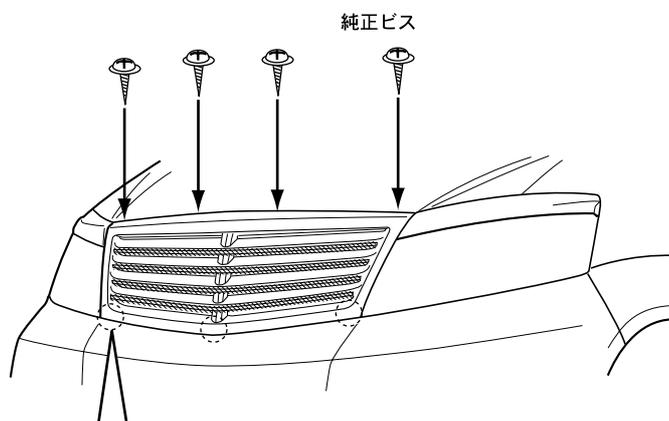
注意) 裏側を差し込む際、ナットが差し込み口に引掛からない様に調節して差し込んで下さい。
