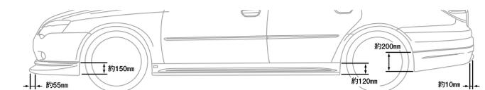
※エアロパーツを装着しますと純正バンパー最下端部より下に「約70mm」下がります。
