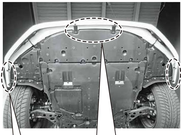
【4】 ①-【3】で取り外した純正ビスの穴位置とZ字ステーの穴位置を合わせ、純正ビスを使用して仮締めしてください。
