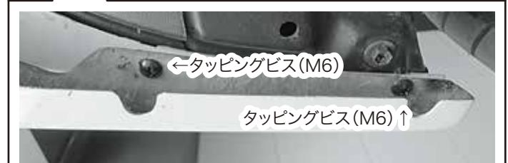
【5】 全体のバランスを確認しながら両面テープを圧着し、仮締めしていたビス等を本締めしてください。
