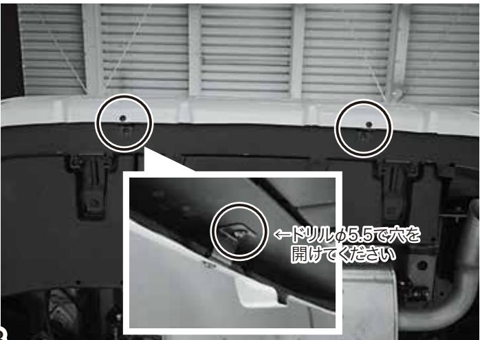
【6】 車両側、両面テープと接する部分をよく脱脂洗浄して下さい。
