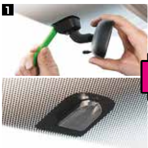
リムーバー等をご使用頂き純正ミラーを外して ください。また、純正ミラー台座はそのまま使いま すので取外さないでください。
