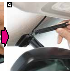
付属の配線カバーを取付けてください。
