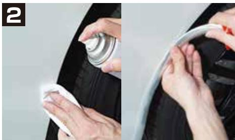
貼付け部分をよく脱脂洗浄した後、付属の両面テープの剥離紙を剥がしながら貼り付けてください。
