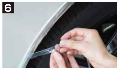
作業完了後、表面の保護シートを剥がしてください。
