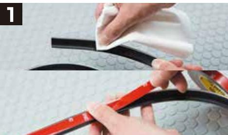
本製品裏側をよく脱脂洗浄した後、付属の両面テープを貼り付けてください。
