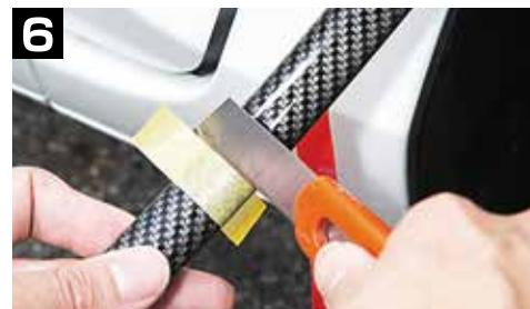
印位置をカットした後、両面テープのハクリ紙を剥しゆっくり曲げ圧着して下さい。
