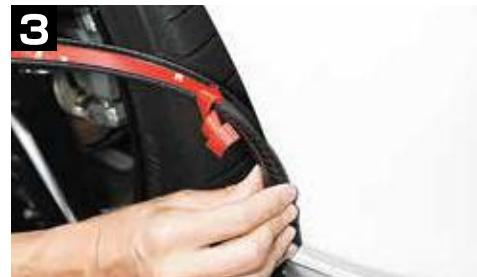
ドライヤー等で十分に温めて、両面テープのハクリ紙を剥しながら、ゆっくり曲げ圧着して下さい。
