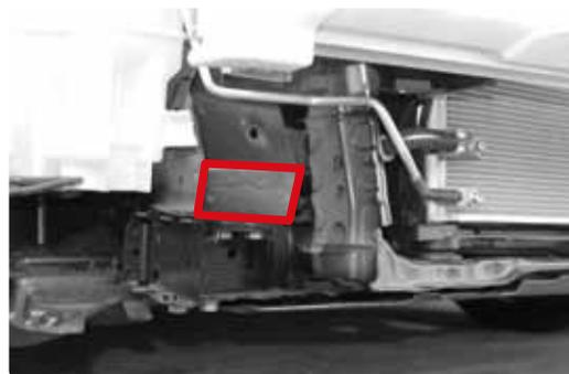
2. イグナイター&バラスト裏側の両面テープのハクリ紙を剥がし図を参考に取付ください。付属のボルト、ワッシャー、SPワッシャー、ナットを使用して固定してください。
