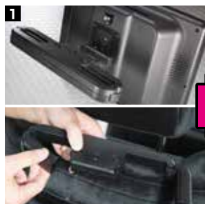
1 モニター裏側のワンタッチブラケットを取り外した後、シャフト部のロックを外してください。
