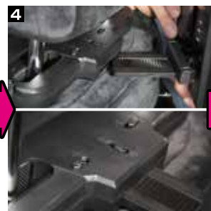
4 モニターを挿入し前後方向を調整しロックを行って下さい。最後にモニターの高さ、角度を調整して完了です。
