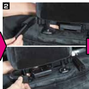
2 ヘッドレストのシャフトに仮あてした後、シャフト径に合わせたシャフトアダプターを取り付けます。 ※シャフト径とアダプター裏面のサイズをご確認の上アダプターを取り付けてください。
