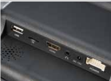
接続端子 AV入力、DVD映像出力、TF/microSDカード、HDMI、USB、ヘッドホン、DC12V
