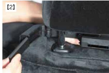
ヘッドレストシャフトの径に合わせたシャフトアダプターを取付けてください。
