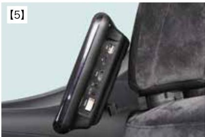
モニターの角度調整を行いディスクの出し入れを確認し、モニターをロックして固定してください。
