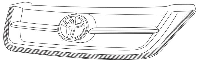
※斜線部をよく脱脂洗浄した後、両面テープを貼付けてください。
