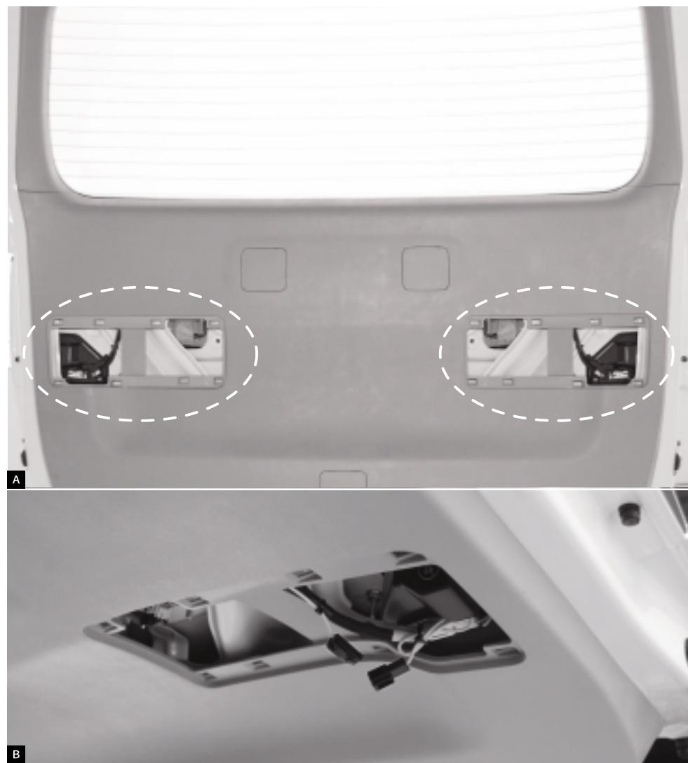
1. 「A」後退灯を交換するためのカバーを外して下さい。(写真参考)
